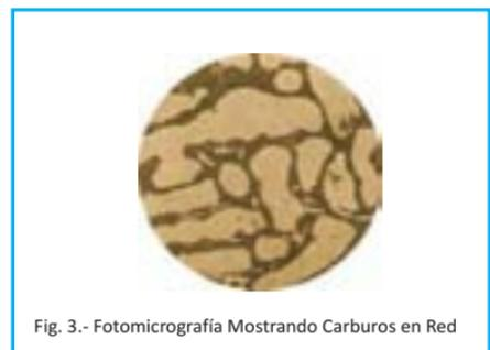
Fig. 3.- Fotomicrografía Mostrando Carburos en Red
