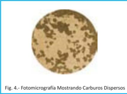
Fig. 4.- Fotomicrografía Mostrando Carburos Dispersos
