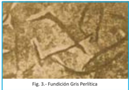
La fundición gris ferrítica, se caracteriza porque las láminas de grafito se encuentran sobre granos de ferrita; mientras que en la fundición gris perlítica, las láminas de grafito se hallan sobre fondo perlítico (oscuro), con la presencia de algunos granos de ferrita (blanco).
