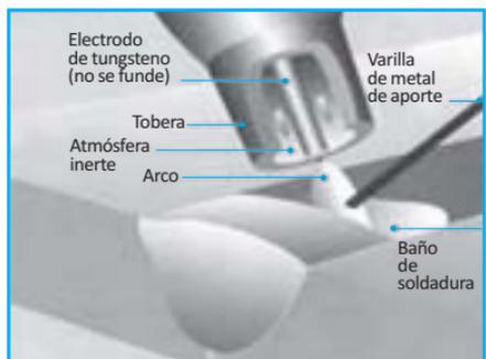
Fig. 22.- Proceso de Soldadura TIG
