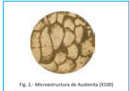
Fig. 2.- Microestructura de Austenita (X100)
