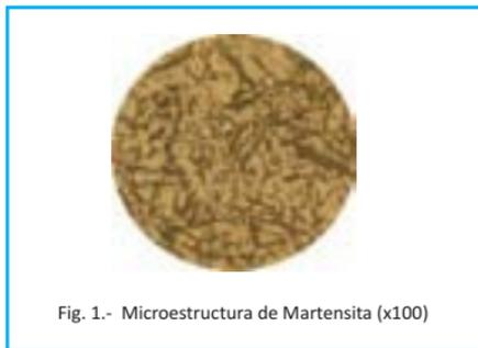
Fig. 1.- Microestructura de Martensita (x100)
