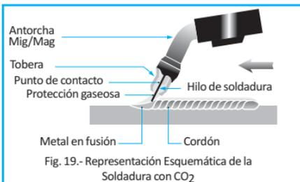
Fig. 19.- Representación Esquemática de la Soldadura con  $CO_2$
