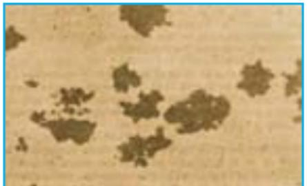
Fig. 5.- Fundición Maleable (Americana)
